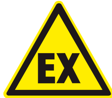
Abb. 13: Kennzeichnung eines explosionsgefährdeten Bereichs
