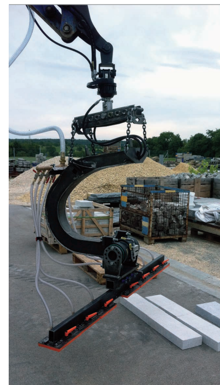
„Steinhart-innotec WV 180“ Bagger-Wendevorrichtung für Pflastersteine
