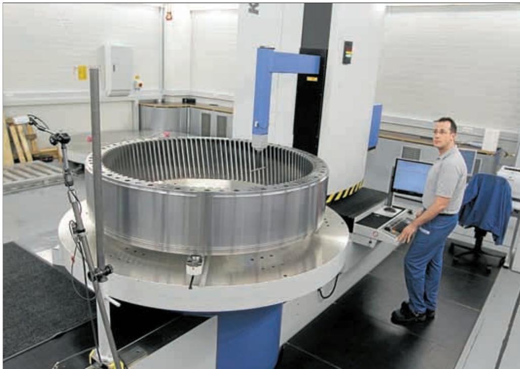
Ein Maschinenbautechniker prüft das Windkraft-hohlrad auf einer Zahnradmessmaschine auf µ-Genauigkeit. Bild: PR-Service
