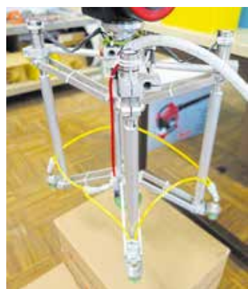
Das format-variable Kartonsauger-Greifsystem der Hipp Engineering wurde 2025 ausgezeichnet. Foto: Kreissparkasse Reutlingen
